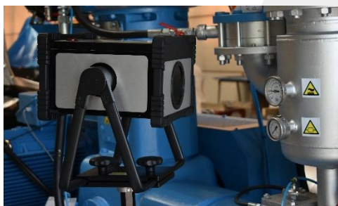
X-RIS a développé sa propre gamme de générateurs de rayons X portables à potentiel constant.
