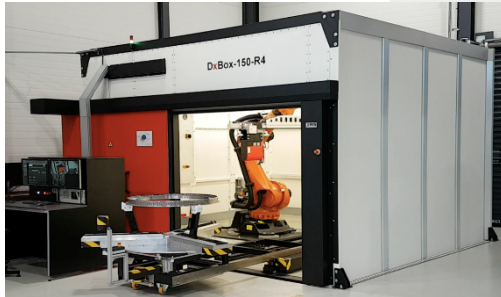
X-RIS offre des solutions rayons X dotées d'électromécaniques complètes et notamment avec des systèmes de positionnement robotisés et multiaxes.
